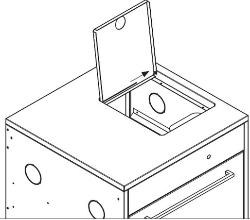
**3** Setzen Sie von oben den Seitenkocher mit Gasregleinheit in die Öffnung des Seitenkochermoduls ein.
