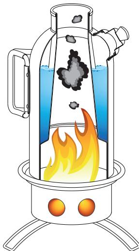
Quand l'eau bout, le sifflet à vapeur placé sur le capuchon de la bouilloire se met à siffler. Vous obtenez ainsi de l'eau bouillante en un rien de temps, même en voyage et par tous les temps. Grâce aux trois pieds, votre Bouilloire à bois Petromax est stable et respecte l'environnement en ne laissant aucune trace de votre feu.
