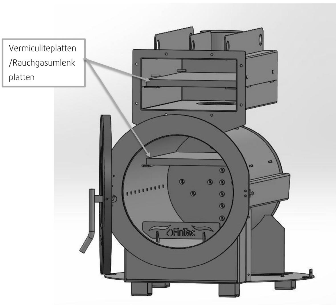
Abbildung 3: Schema Zusammenbau Vermiculite
