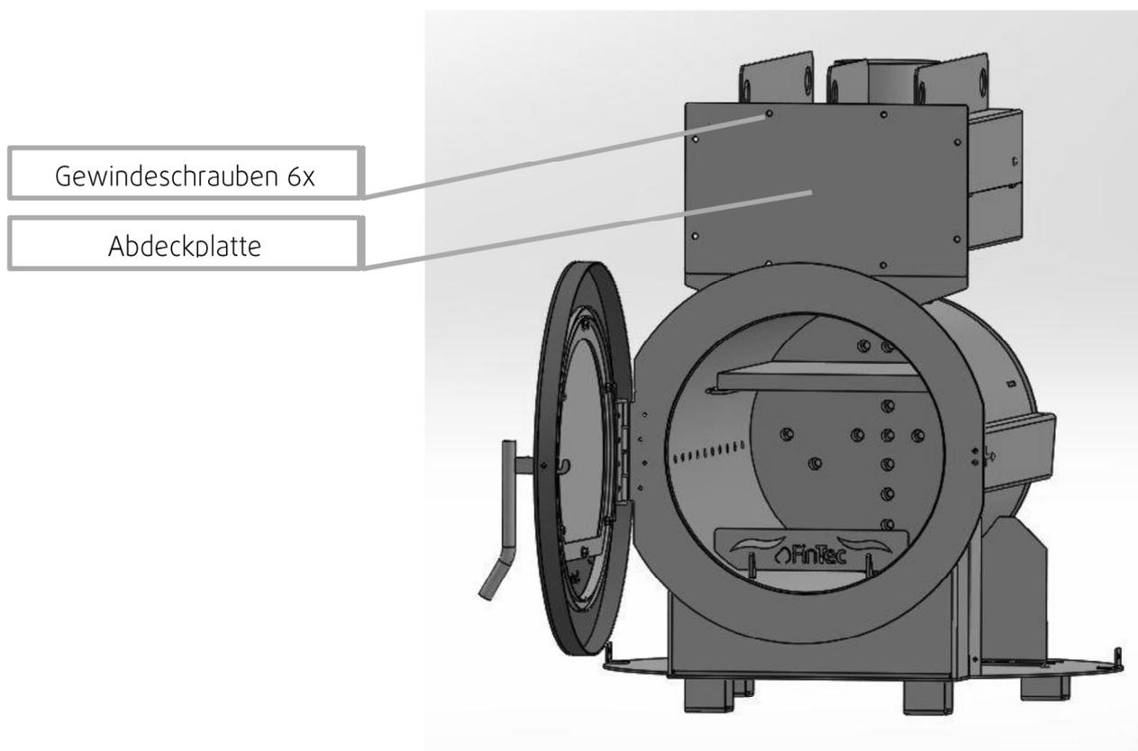
Abbildung 4: Reinigung Nachbrennkasten
