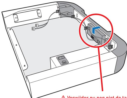
⚠ Verwijder nu nog niet de tape van het bedieningspaneel.
