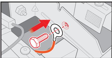
**△ ALLEEN 435 MODELLEN:** Bevestig de verbindingsring met een schroef stevig aan het verdeelstuk.
