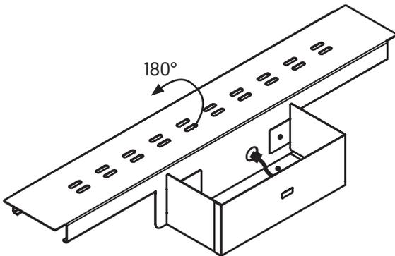
**7** Befestigen Sie die Halterung der Elektronik-Einheit vom Original-Seitentisch am Elektronikträger mit 2 Stk. M4 Schrauben.
