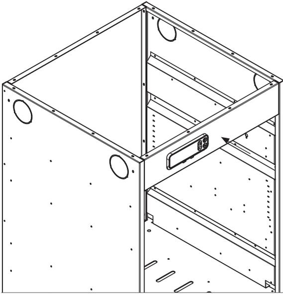
**5** Befestigen Sie die Basis des Connects am Elektronikträger mit 2 Stk. M4 Schrauben.
