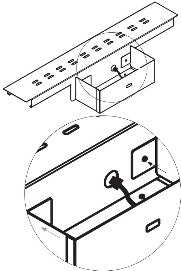
**6** Drehen Sie die Basis des Connects am Elektronikträgers um 180°.
